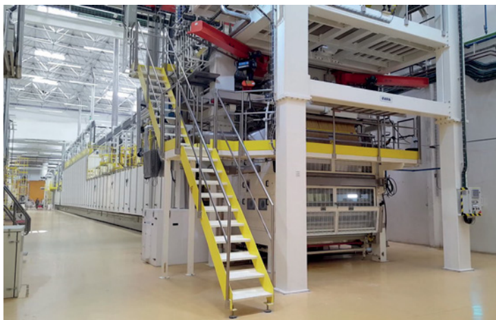
GPL 180, 6.000 kg/h di pasta lunga, la più potente della nuova generazione (Fava).
