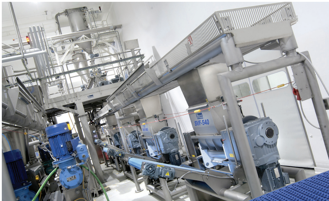
Linea di produzione di pasta fresca monosfoglia con distribuzione tramite navetta di impasto e ripieno a 4 stazioni di formatura (Fava Storci).
