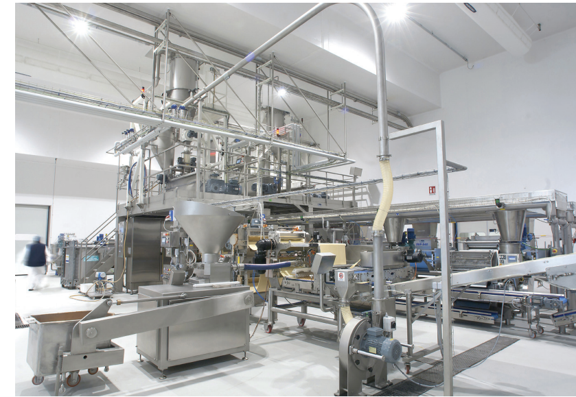
Linea di produzione di pasta fresca doppia sfoglia, dettaglio su raviolatrice e pompa di dosaggio del ripieno (Fava Storci).
