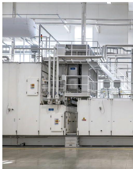
Linea pasta lunga GPL 180 da 4000kg/h e dettaglio della zona di ingresso del raffreddatore (Fava Storci).
