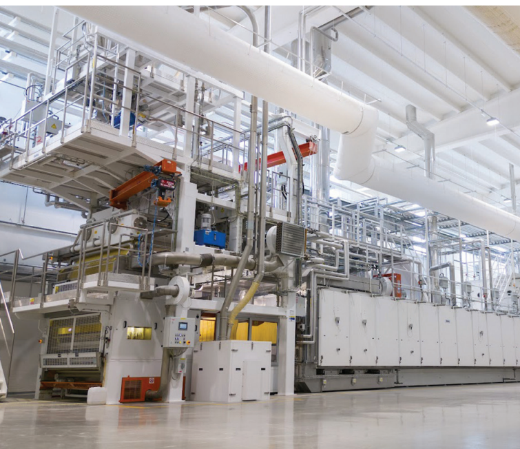
Linea pasta lunga GPL 180 da 4000kg/h e dettaglio della zona di ingresso del raffreddatore (Fava Storci).
