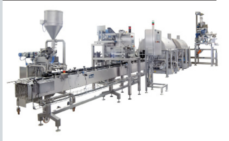
LIGNE AUTOMATIQUE DE PESAGE ET DOSAGE DE SAUCE POUR PLATS CUISINÉS
