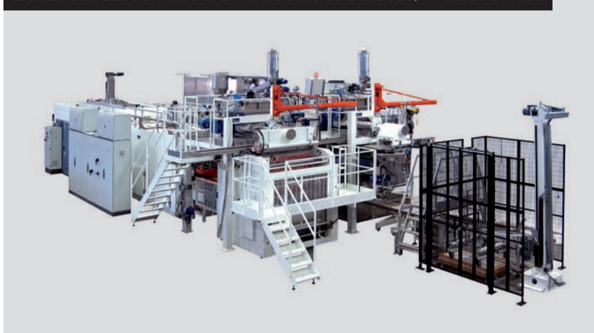
LIGNE POUR LES FORMATS SPÉCIAUX DE PÂTES LONGUES, COURTES ET NIDS
