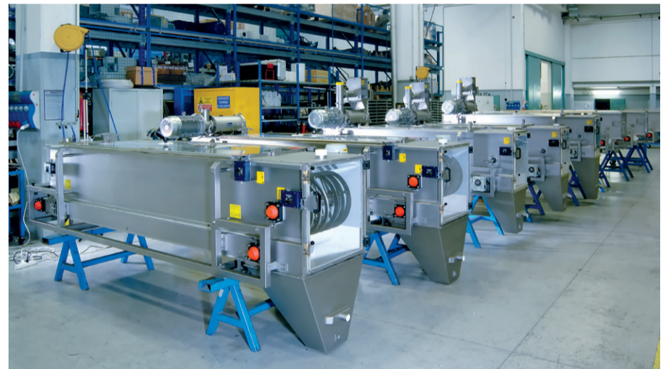
Beltmix in costruzione nelle officine Fava Storci
