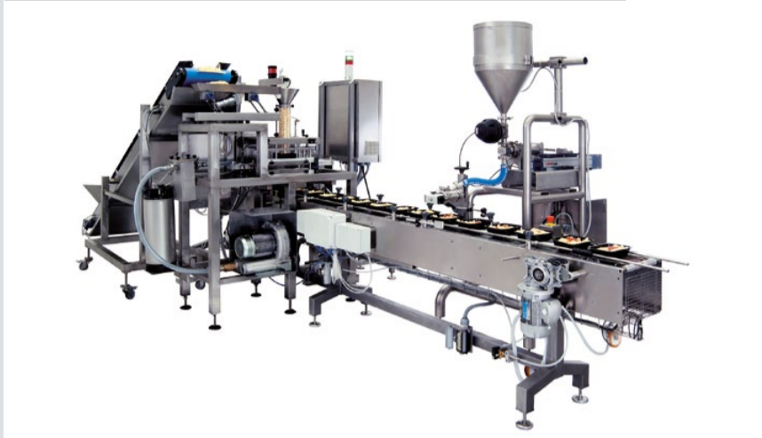
LINEA AUTOMATICA DI PESATURA E DOSAGGIO SALSA PER PIATTI PRONTI
