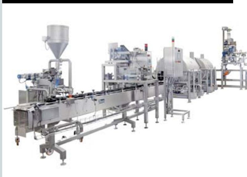
LINEA AUTOMATICA DI PESATURA E DOSAGGIO SALSA PER PIATTI PRONTI
