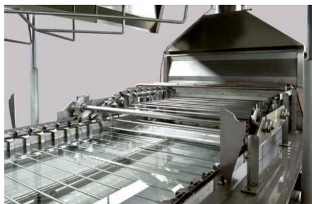
Nel caso di nastri di trasporto della sfoglia realizzati in maglia di acciaio inox, la maggiore resistenza meccanica nel tempo, rispetto ai nastri in materiale termoplastico, causa un elevato consumo energetico dovuto alla necessità di riscaldare non solo l'acqua nella vasca e la sfoglia in ingresso, ma anche la rilevante massa metallica del sistema di trasporto.
