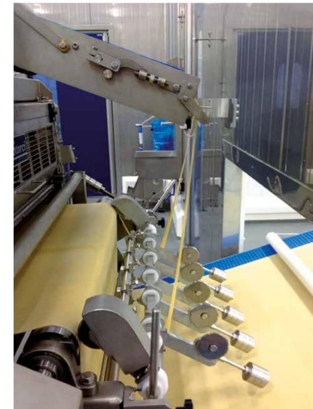
tratto immerso, oppure il cliente deve accettare di avere dei tempi di cottura diversi, magari intervenendo sulla temperatura del bagno di cottura per cercare di compensare i diversi tempi di immersione. Il sistema di trasporto Storci risolve questo problema modificando il punto di immersione della sfoglia.
