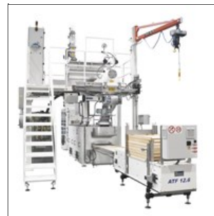
Avanzamento telai su linea pasta corta
