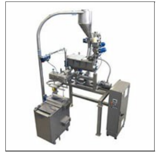
Pressa 72.1-580/1 TV/L Pressa per paste lunghe (vista dall'alto completa di stenditrice e sistema di recupero sfridi)
