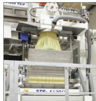
Application STE 1120 sur ligne Omnia avec cône de distribution à "champignon"
