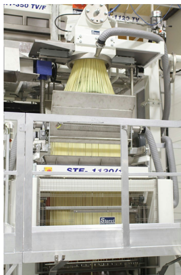
Aplicación práctica STE 1120 en línea Omnia con cono separador para cabezal circular
