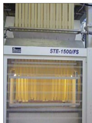
Particolare STE 1500 FS produzione lasagne americane
